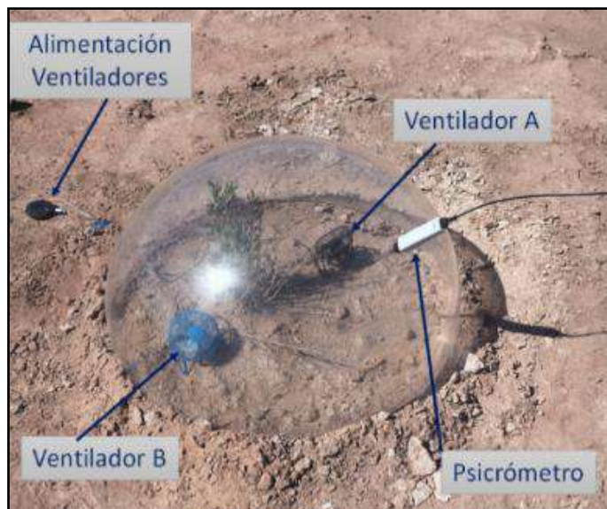
Figura 4-18 Esquema de la cámara semiesférica dispuesta en terreno, con ventiladores y psicrómetro instalados
