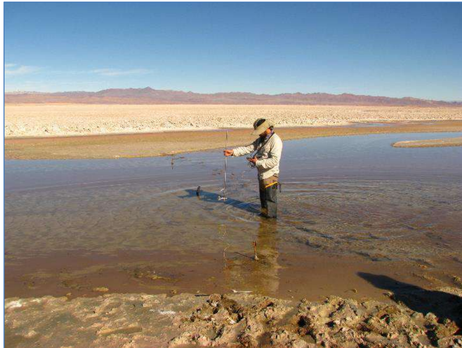
Figura 4-24 Aforo con molinete
