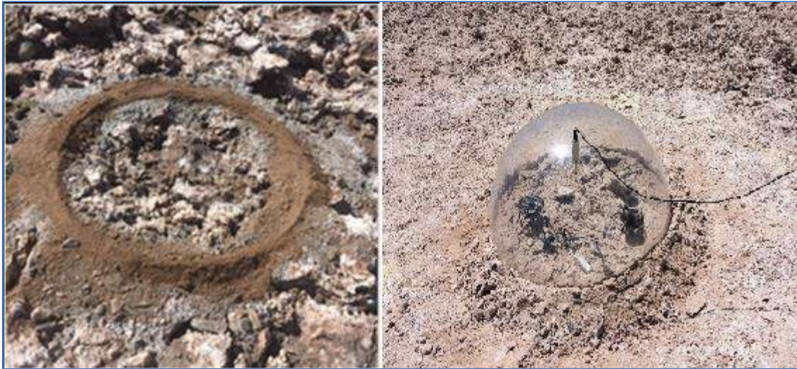
Figura 4-19 Preparación del terreno e instalación del domo
