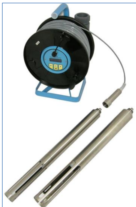
Figura 4-28 Sonda SEBA Hydrometrie con sensor MPS-D3
