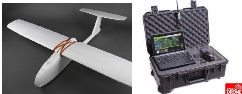
Figura N° 4-7. Equipos utilizados en levantamiento fotogramétrico: Dron de ala fija o UAV (Unmanned Aerial Vehicle, izquierda) y estación de control de vuelo (derecha)
