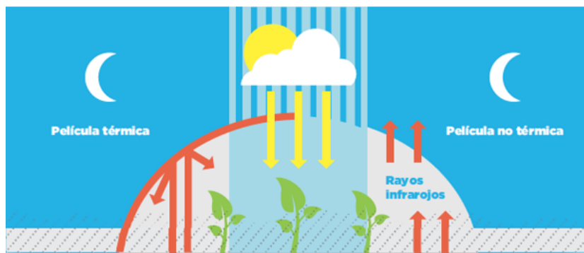
Figura 4-4: Propiedades de la cubierta térmica
