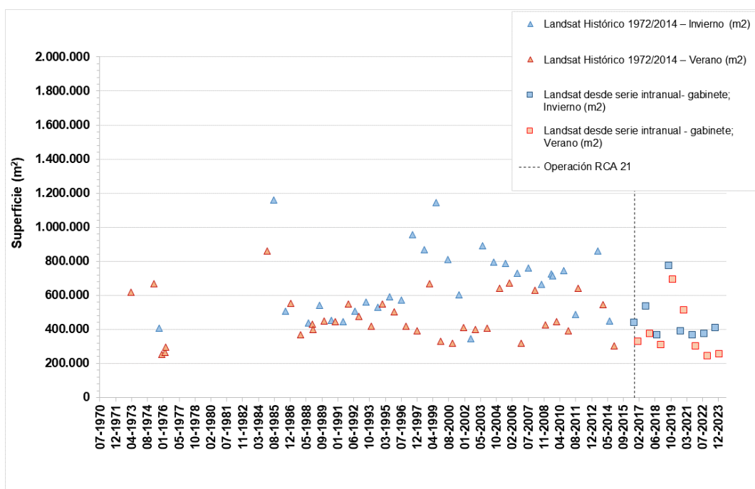
Figura N°13-128. Variación interanual de las superficies lagunares mediante el uso de imágenes Landsat, Sector Peine.
