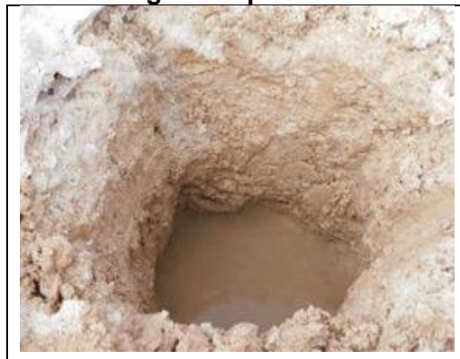
Fotografía N° 9-43. Vista general perfil calicata S 3. Verano 2023.
